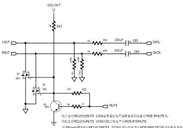
(1)、上图采用的是增加一个三极管、2个 mos 制作的静音电路，用 MCU 的一个 IO 口作为控制脚。上电的时候，
