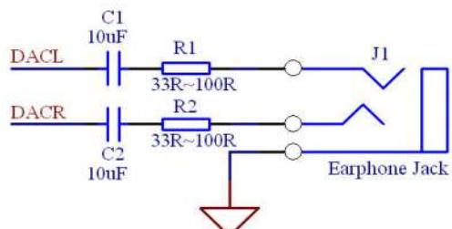
(1)、左边的图，DAC 输出经过电解电容隔直，电容 C1、C2 将决定低音的效果。电容越大，低音效果越重，而 R1、R2 是为了消除耳机插入的瞬间“啪啪声”
