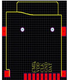
最左边的为第一脚。这种卡座最方便，这种卡带 GPIO 检测，也带 CLK 检测，还可以用 CMD 检测。使用最为广泛，且单价成本最低的卡槽
