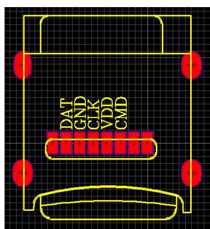
这种卡不带 GPIO 检测，也不带 CLK 检测，只能采用 CMD 检测。此卡座的特点是内焊式，可以完全的固定好 TF 卡。最好用于工业方面
