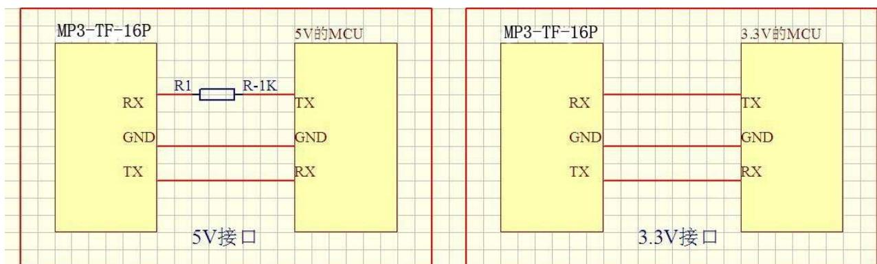
模块的串口为 3.3V 的 TTL 电平，所以默认的接口的电平为 3.3V。如果系统是 5V。那么建议在串口的对接接口 TX 和 RX 串联一个 1.5K 左右的电阻。这样足以满足一般的要求，如果应用于强电磁干扰的场合，请参考“注意事项”的说明。模块在 5V 和 3.3V 的系统中均正常的测试过，一切正常。均在采用的是直连的方式，并没有串 1K 的电阻。
